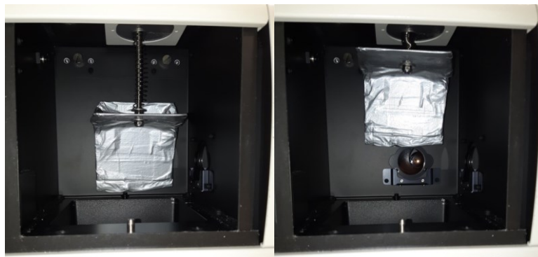
Abbildung 104. Selbstgebauter Shutter mit Federmechanismus zum Verdecken der Lichtquelle des Spektrometers. Geschlossen (links) und offen (rechts). Der Probenhalter wurde für die Fotos ausgebaut. [215]
