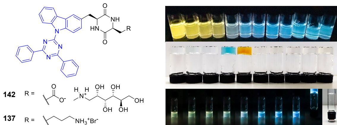
Abbildung 95. Links: Struktur der DPhCzT (blau)-abgeleiteten Gelatoren auf DKP-Basis. Rechts (von oben nach unten): AIBSE-Verhalten von 137 in DMSO/H 2 O-Gemischen unter UV-Licht ( c = 100 \mu\text{M} ); Hydrogele von 142 nach Zugabe verschiedener Salze zu dessen Sol; Gelierung von 142 nach Erhitzen in einem H 2 O/MeCN-Gemisch unter UV- und Tageslicht. [184]
