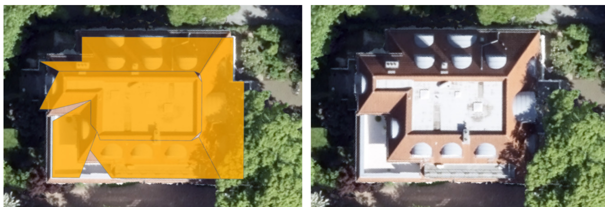
Abbildung 7: Gegenüberstellung - als PV-Flächen erfasste Einzelflächen des Gebäudes (links, orange) und Luftbildaufnahme desselben Gebäudes (rechts) mit deutlich erkennbaren Ausbauten (z. B. Gauben) sowie Balkonflächenanteilen © Landesamt GeoInformation Bremen 2023
