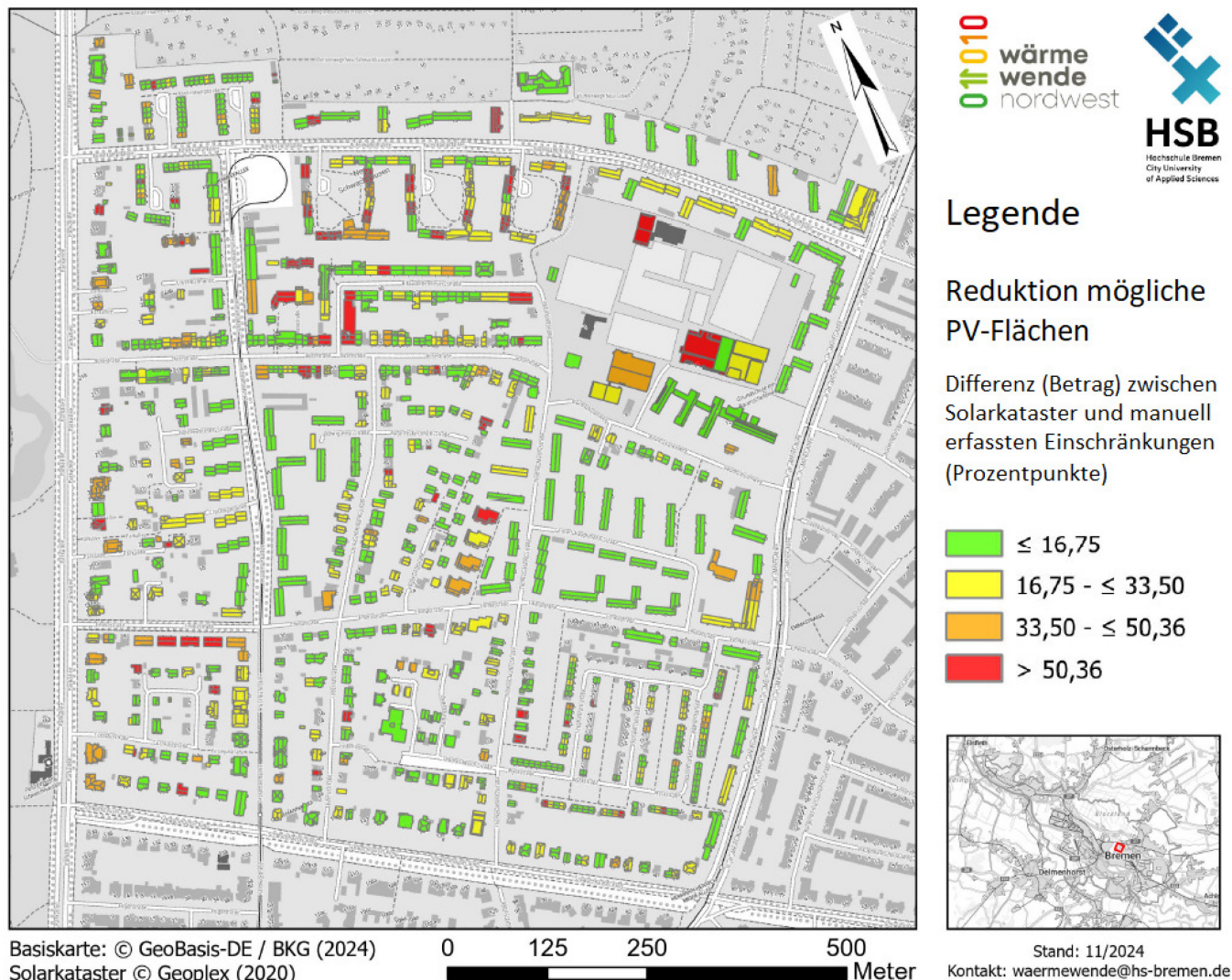
Abbildung 8: Übersichtskarte Projektgebiet Neu-Schwachhausen mit farbllichem Überblick der betragsmäßigen Differenzen zwischen manuell erfassten (prozentualen) Flächeneinschränkungen und den (prozentualen) Reduktionsangaben aus dem Solardachkataster für die Belegung von Dachflächen mit PV-Modulen
