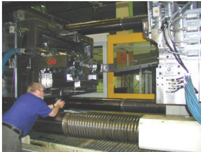
Abbildung 5: Großwerkzeug in geöffneter Stellung in der Spritzgießmaschine
