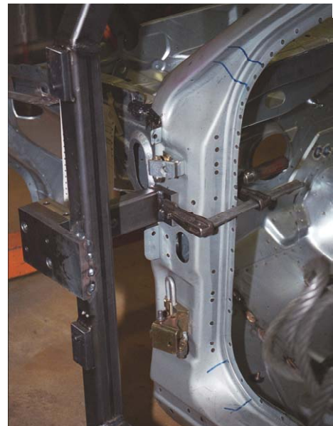
Abbildung 7: Anpassung des Träger-Rahmens der Vorrichtung an die Rohkarosserie (linkes Bild), Feinjustierung der Vorrichtung an der Vorderseite der Karosserie (rechtes Bild)
