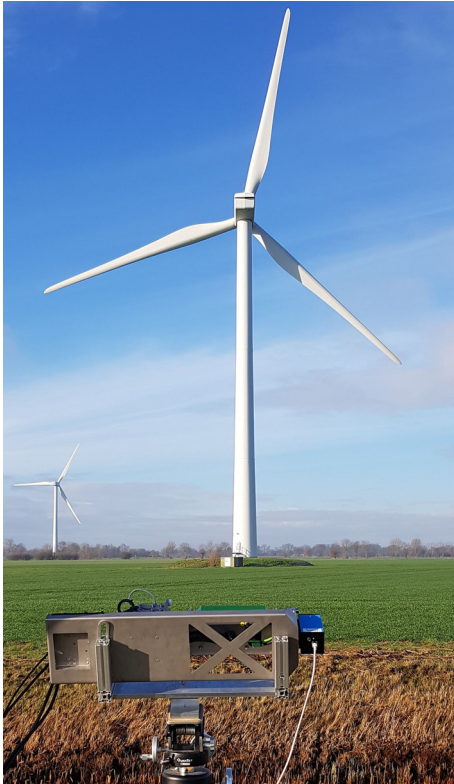
Abb. 5: TLS-Messung an einer WEA aus einem Abstand von d \approx 150 m.
