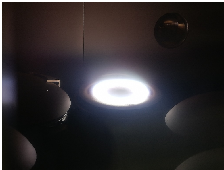
Abbildung 3.3: Gold-Argon-Plasma beim Abscheidungsprozess.
