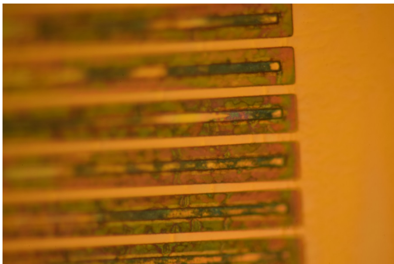
Abbildung 6.11: Probe mit jeweils 50 nm dicker Titanoxidschicht nach Versagen. Deutliche Auflösung der Leiterbahnen.
