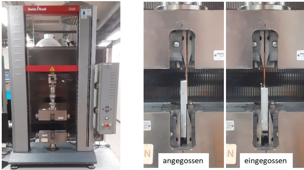
Abbildung 34: Zwick-Roell-Prüfmaschine Z020 mit einer maximalen Prüflast von 20 kN links sowie eingespannte angegossene und eingegossene Probengeometrie
