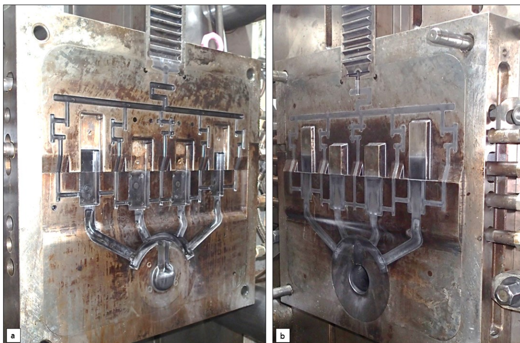
Abbildung 29: Geöffnetes Gießwerkzeug mit der beweglichen (a) und festen Formhälfte (b)
