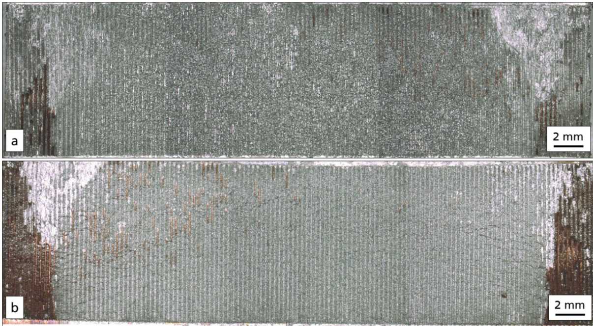
Abbildung 110: Bruchbilder einer angegossenen Verbundgussprobe mit einer Oberflächenstruktur im vorderen Angussbereich jeweils von der Aluminiumkomponente in a sowie der Kupferkomponente in b
