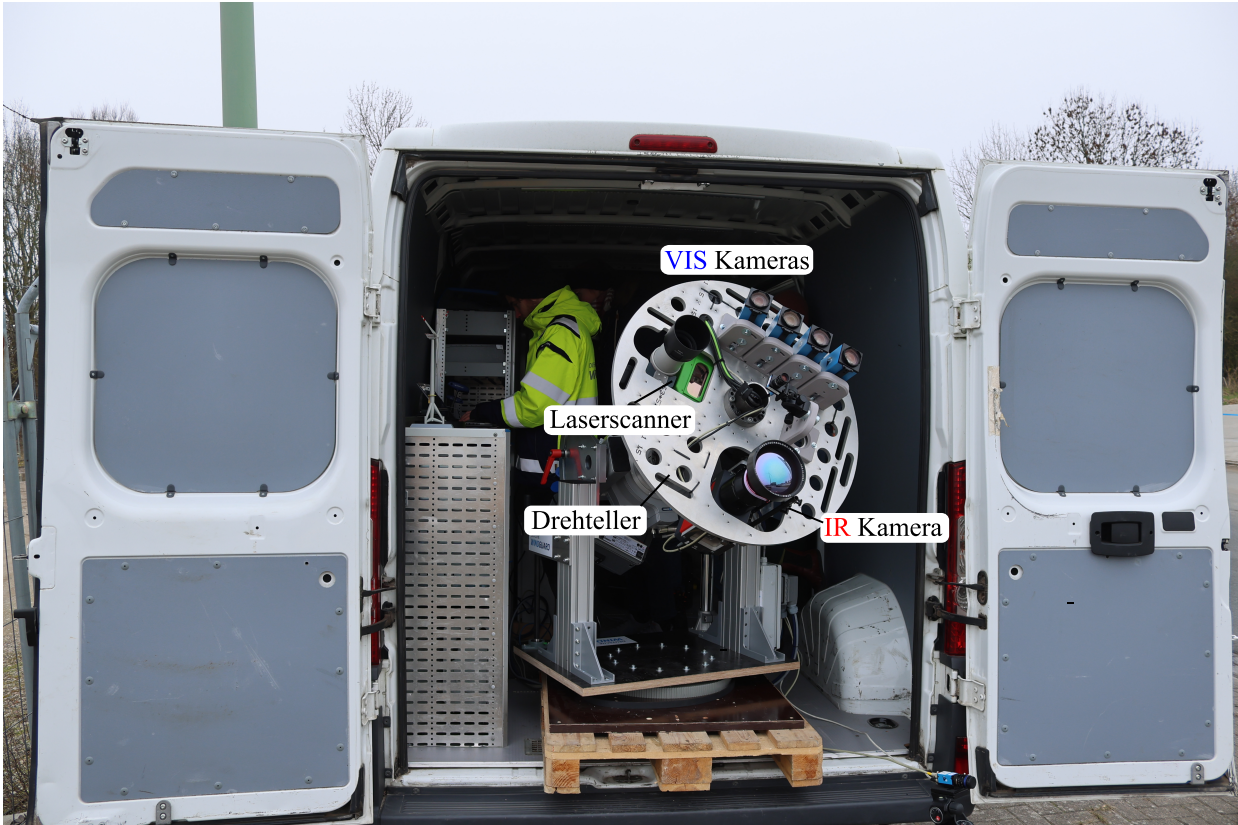
Abb. C.3: Prototyp eines mit der WEA mitrotierenden Messsystemträgers.
