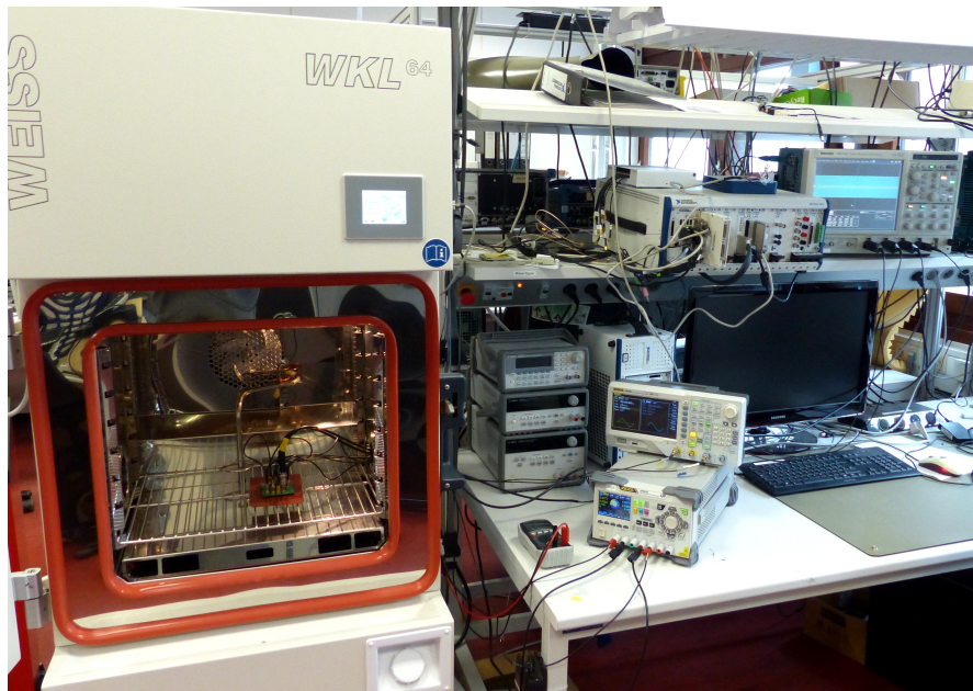
Abbildung 6.22.: Messaufbau für die Temperaturmessung im Klimaschrank.
