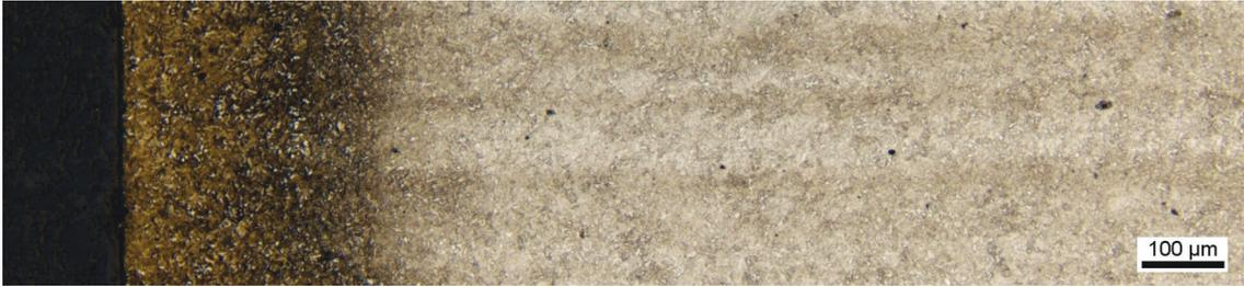
Abb. 3: Diffusionsschicht eines vergüteten Nitrierstahls 31CrMoV9, nitriert bei 570 °C, 14 h und  $K_N = 1,0 \text{ bar}^{-1/2}$  (Ätzung: 3 %ige alkoholische  $\text{HNO}_3$ ). Untersuchung im Rahmen von [115].
