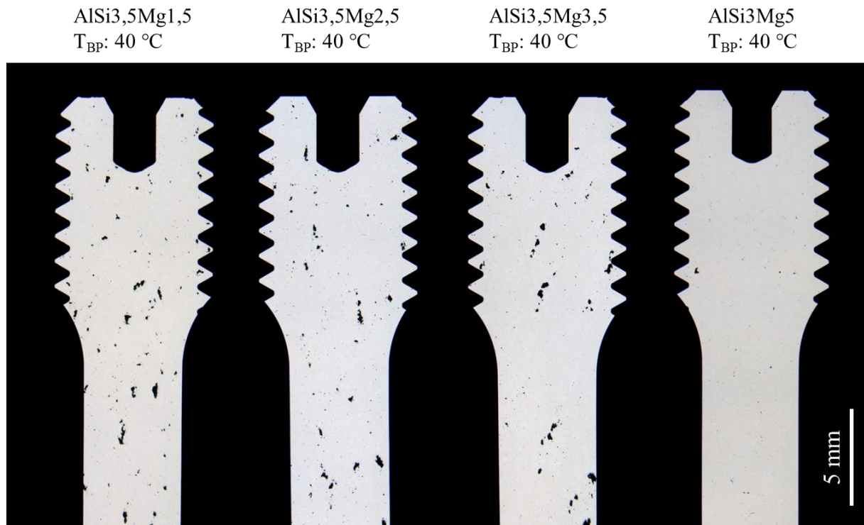
Bild 5-49 Porosität im ungeätzten Schliffbild in Zugproben jeder Legierungsvariante nach mechanischer Prüfung, PBF-LB/M-Plattformtemperatur: 40 °C
