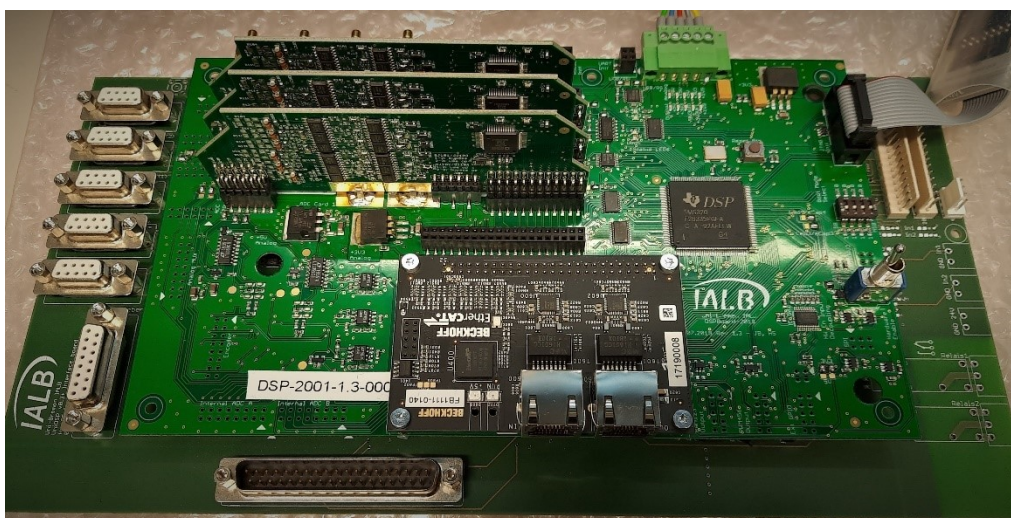
Abbildung 7-24: DSP des HiL-Rotors mit EtherCAT Briefmarke
