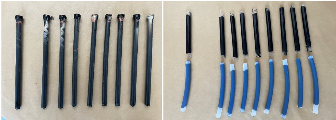
Abbildung 54 - Statikmischer (links) sowie Liner (rechts) nach dem Versuch
