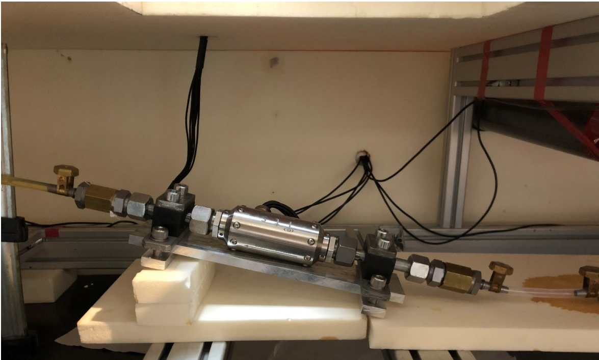
Abbildung 63 - Montage-Position des ECT-Sensors
