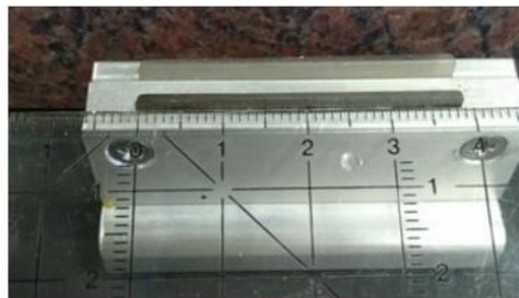
Stanzwerkzeug für Dünnpfilme ( b = 5,7 \text{ mm} ; l = 38 \text{ mm} )
