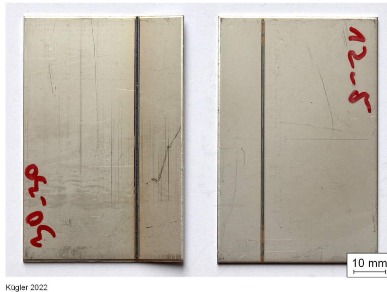
Bild 4.7: Beispiele von Proben aus dem Biegeprozess (links: 30 Bestrahlungszyklen, rechts: 5 Bestrahlungszyklen)
