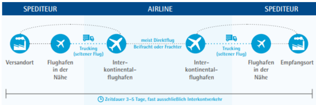
Abbildung 6: schematische Darstellung des Luftfrachtprozesses in der konventionellen Fracht. Quelle: (IHK München, 2018)
