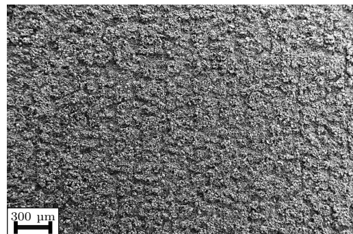
Abbildung 5-29: Links: Profilkurven aus der Rauigkeitsmessung; rechts: REM-Aufnahmen der Grünteiloberfläche
