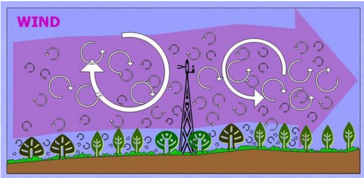
Figure 2.3: Illustration of eddies superimposed onto the mean wind ( https://upload.wikimedia.org/wikipedia/commons/6/65/Py%C3%B6rrekovarianssi-tekniiikan_k_aaviokuva.jpg ).
