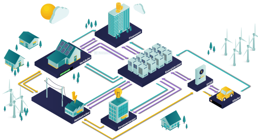
Abbildung 15: Schaubild des regenerativen Energiesystems mit seinen Elementen und Akteuren. Rechts und links sind Windenergieanlagen zu sehen, im rechten Bereich ein elektrisch angetriebenes Auto mit einer Ladestation, welche mit einem Energiehändler, hier Energiebroker genannt, verbunden ist. Der Energiehändler ist hier symbolisch mit Speicherblöcken dargestellt, da er in der Lage ist, Energie auf Vorrat zu kaufen und bei günstigen Marktbedingungen wieder zu verkaufen. Im Vordergrund sind Stromversorger und Netzbetreiber zu sehen, die ihre Energie mit Verkäufern handeln.
