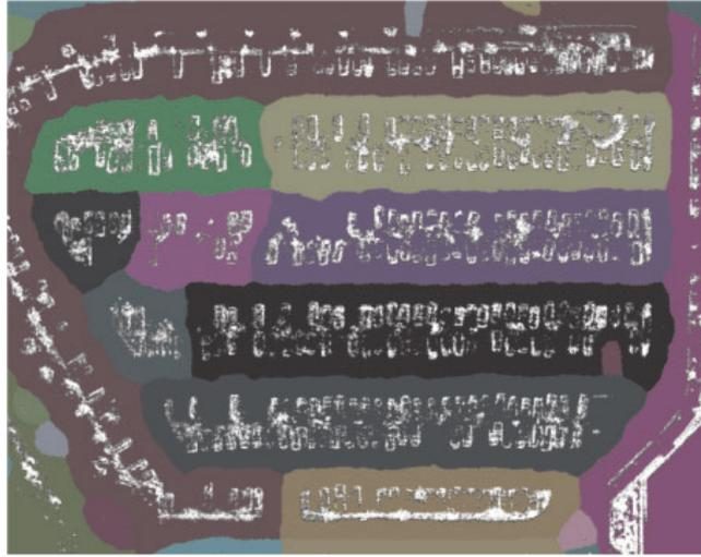
**Abbildung 2.12:** Voronoi-Diagramm für die Punktvolke aus Abbildung 2.11, nach [25]. Die gegebenen Datenpunkte sind jeweils in weiß und die Zellen des Voronoi-Diagramms durch die verschieden gefärbten Bereiche gekennzeichnet.
