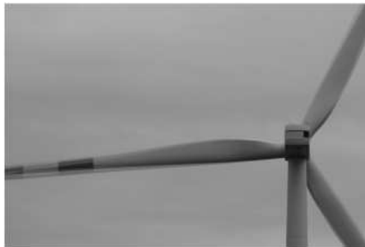
Abb. 3.9.: Überlagerung von drei Bildern einer Bildserie mit den Maximalabweichungen von der mittleren Rotorblattposition.
