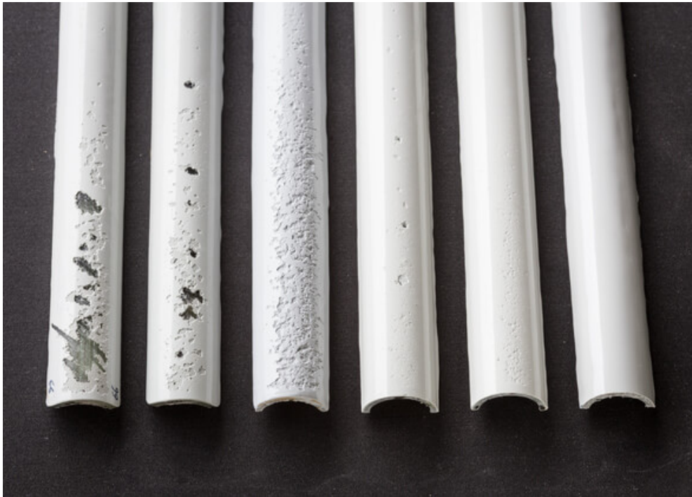
Abbildung 5: Probekörper mit unterschiedlich stark ausgeprägten Erosionsschäden (Vorgängerprojekt REGRO). Die Schäden können mit den Methoden der beteiligten Forschungserichtungen umfassend charakterisiert werden.
