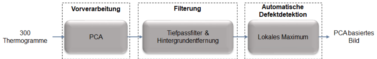
Abbildung 40: Signalflussdiagramm der Bildverarbeitungsvorgänge.
