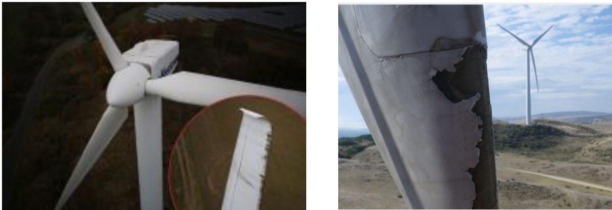
Abbildung 1: a) WEA mit degradiertem Rotorblatt ( http://www.FAZ.net ), b) Detailaufnahme eines Erosionsschadens an einer WEA [6].
