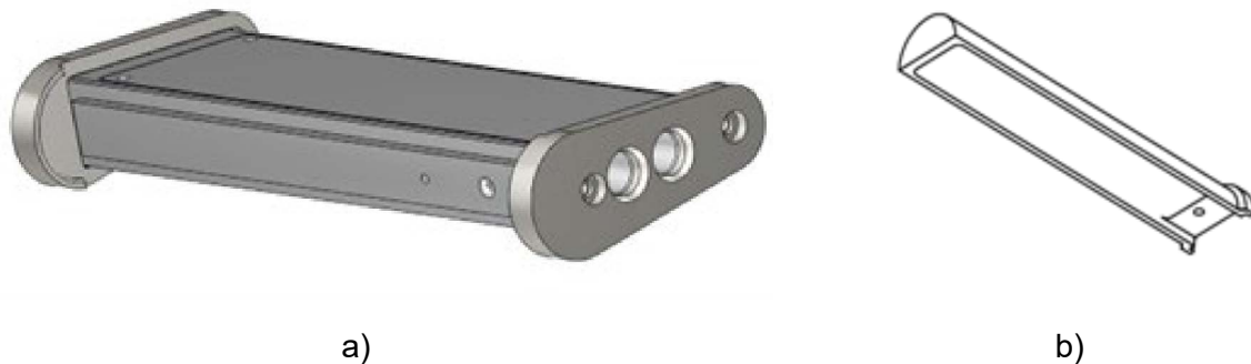
Abbildung 13: Probenhalter für die halbrunden Probekörper im Regenerosionsprüfstand für a) 236 mm Proben und b) 50 mm Proben
