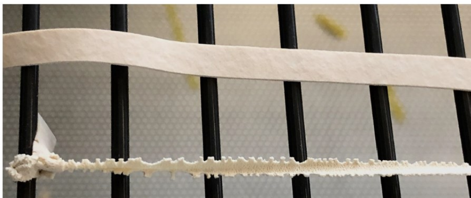
Abbildung 4 [36], S. 5: Durch Reaktion mit Ozon verursachte Schäden an dem Gummiband einer Atemschutzmaske. Diese wurde 30 Minuten einer Konzentration von 20 ppm ausgesetzt. Das Band stand während der Begasung unter Zug und riss auch nach Ende des Experiments trotz der offensichtlichen Schäden nicht. Um ein solches Szenario zu vermeiden, sollte die Ozonverträglichkeit aller benutzten Materialien (falls nicht vorher bekannt) ausgiebig über mehrere Zyklen getestet werden.
