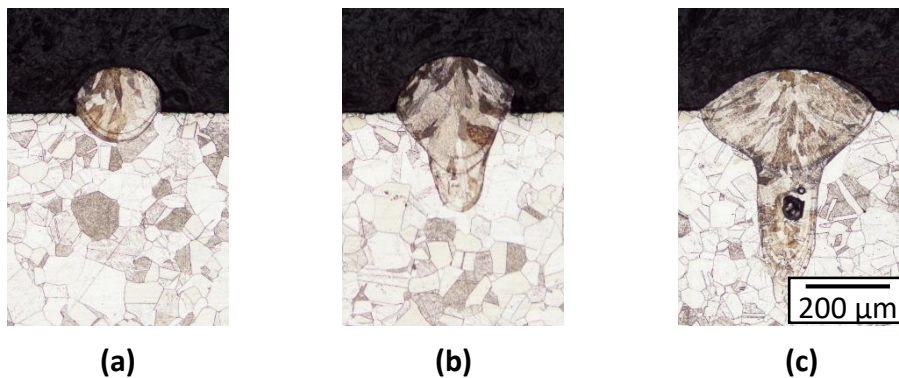
Abb. 5.2.: Schliffbilder von Einzelspuren bei der Scangeschwindigkeit v = 100 \text{ mm/s} und variierender Laserleistung bzw. dimensionsloser Schmelzenthalpie in (a) P = 125 \text{ W} , \Delta H/h_s = 3,36 , in (b) P = 225 \text{ W} , \Delta H/h_s = 6,04 und in (c) P = 325 \text{ W} , \Delta H/h_s = 8,72 .
