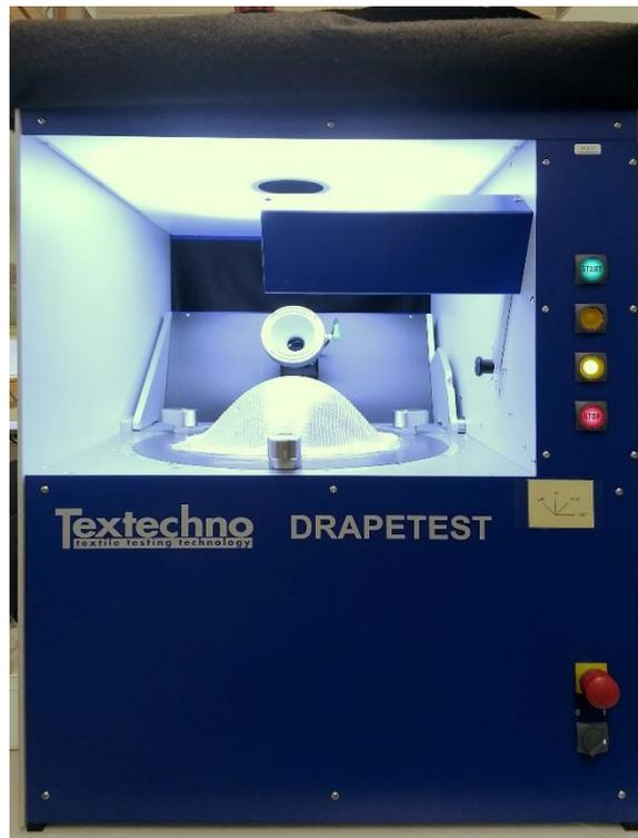
Abbildung 1 DRAPETEST mit aktiver Beleuchtung nach Abschluss eines Drapiervorgangs
