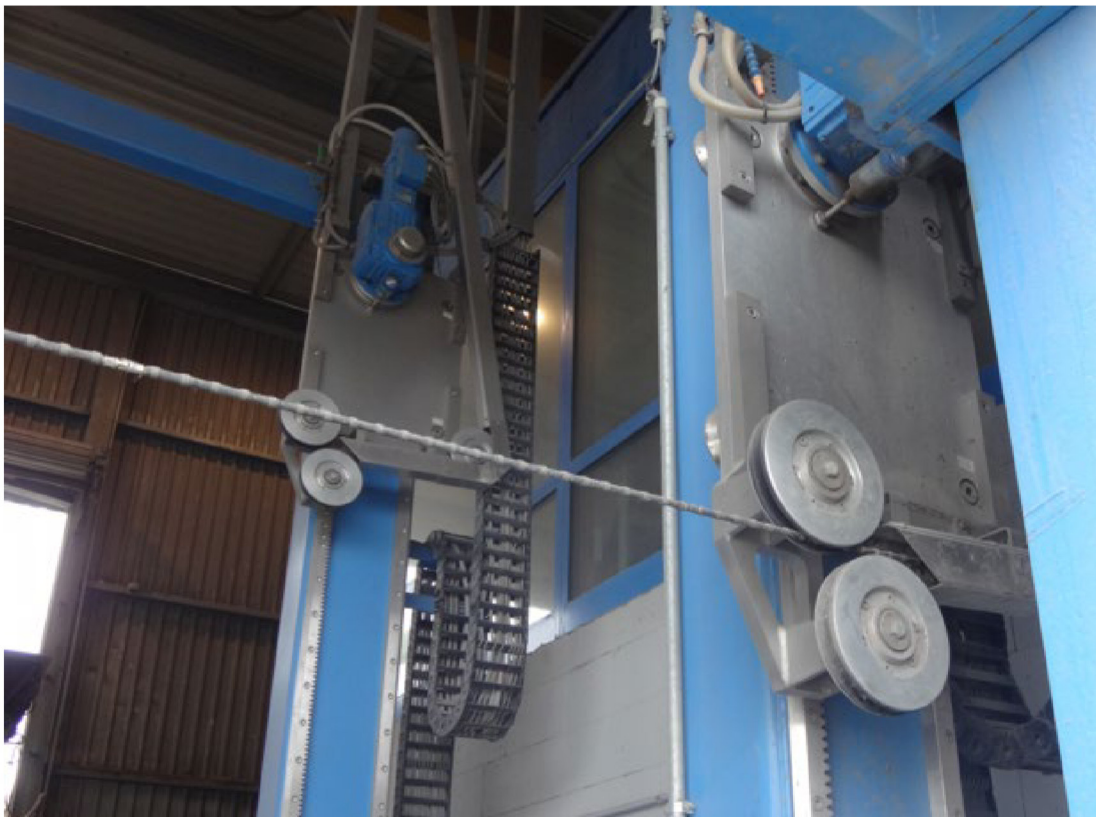
Abbildung 61: Seilsäge zur Rotorblatzerkleinerung (ehemals Fa. Zajons Lüneburg). (Rausch 2020) Abdruck mit Genehmigung von Nehlsen AG.
