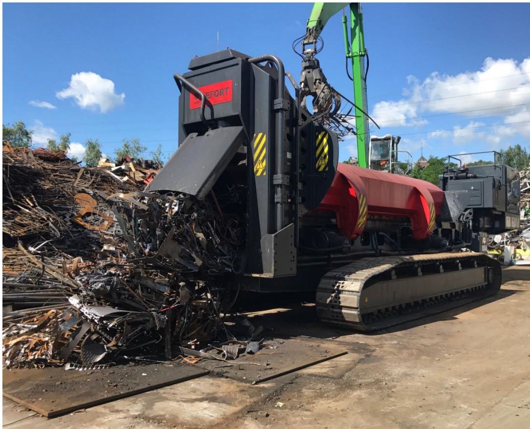
Abbildung 54: Exemplarisch mobile Schrottschere Lefort TRAX 1 000. (Lefort Deutschland GmbH ohne Jahr) Abdruck mit Genehmigung von Lefort Deutschland GmbH.
