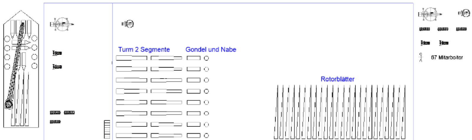
Abbildung 68: Legende Layout Hafenschrottplatz 400 m x 150 m und Anlanden von 8 WEA mit einem Errichterschiff. (Projekt SeeOff)
