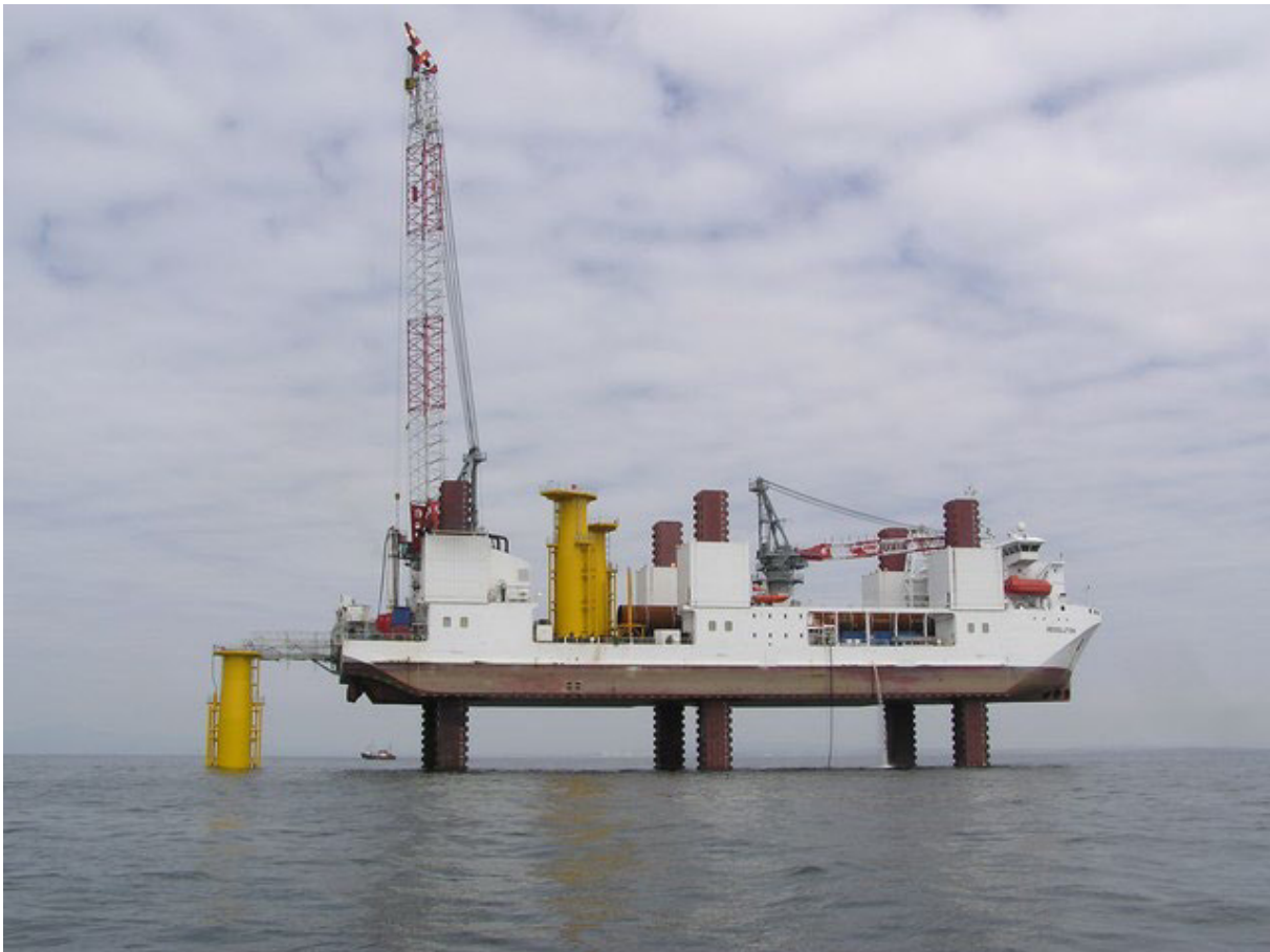
Abbildung 55: Errichterschiff MPI Resolution (Price 2005).
