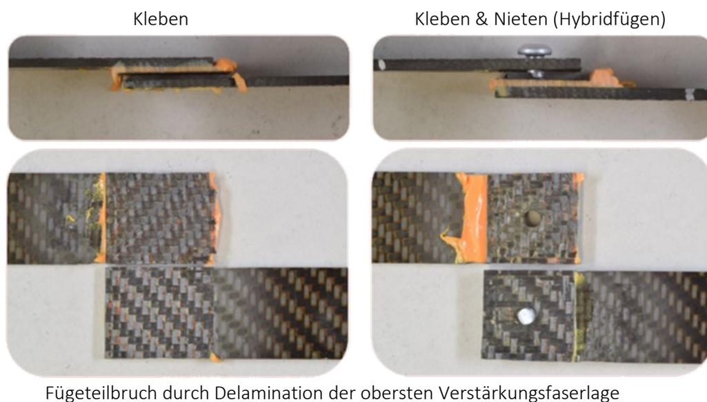
Abbildung 40: Schematische Darstellung des Bruchbildes (Fügeteilbruch) von geklebten und hybridgefügten PBF-a-basierten FKV anhand des Beispiels von KPV.
