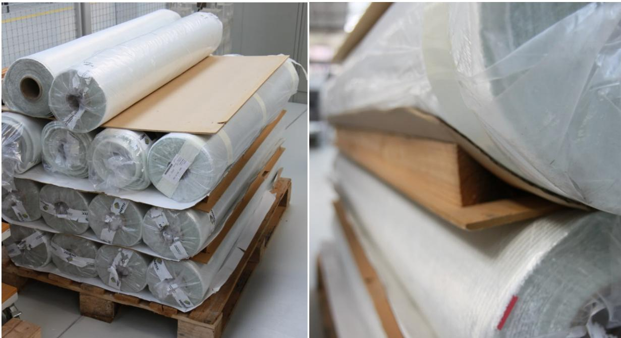
**Abbildung 2-6: Beispiel für eine typische Lagerung von Textilrollen auf einer Palette**
