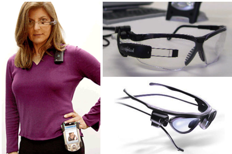
Abbildung 9: links: MicroOptical Display mit Bluetooth-Verbindung zum PDA, rechts: aktuelles monokulares MicroOptical-HMD (an Standardbrille), MicroOptical Designstudie für ein integriertes HMD mit Headset und Kamera
