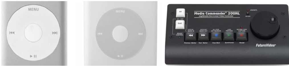
Abbildung 11: links u. mitte: iPod Click Wheel Konzept, rechts: Jog Dial in der Videobearbeitung
