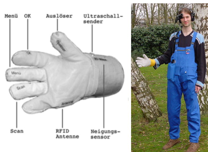
Abbildung 7: links: Winspect-Handschuh, rechts: Winspect-Gesamtsystem
