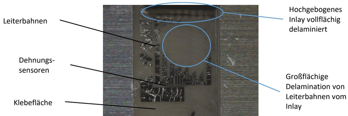
Abbildung 7.13: Delaminierter Sensor nach der Werkstückpräparation zum Festwalzen.
