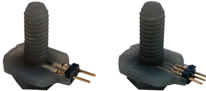
Abbildung 6.6: Foto von ABS Flex Schrauben mit integrierten Sensoren. Eine Lageabweichung des Sensors im linken Bild ist zu erkennen. [92]
