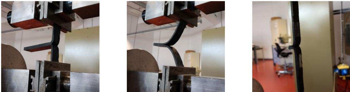
Abbildung 5.14: Messung des Weiterreißwiderstands der Gummimischungen mit eingebrachter Polyimid-Folie.
