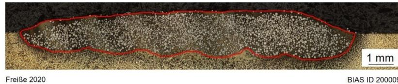
**Bild 4.15:** Messung der Querschnittsfläche  $A_S$  an mehrspurigen hartpartikelverstärkten Schichten
