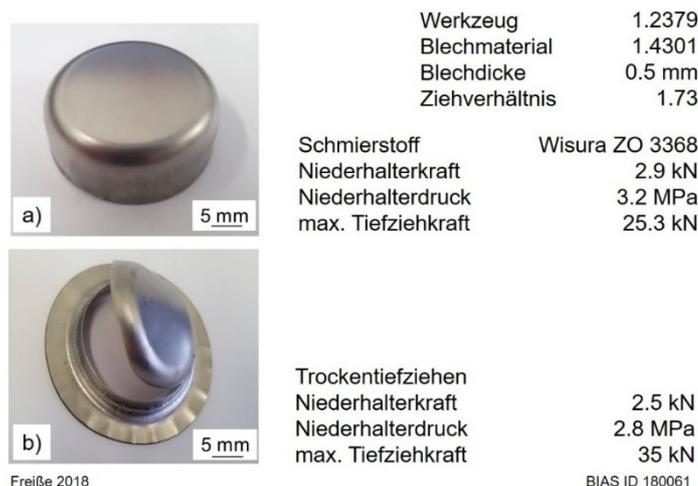
**Bild 5.46:** Tiefziehen mit dem gefrästen Werkzeug aus Kaltarbeitsstahl (Werkzeug 1) mit einem Ziehspalt von 0,7 mm; a) tiefgezogener Napf im geschmierten System, b) Napf nach dem Trockentiefziehen mit gleichzeitig auftretender Faltenbildung und Bodenreißer
