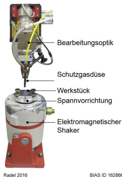
Bild 4.1: Versuchsaufbau zum Laserstrahlschweißen mit Schwingungsüberlagerung
