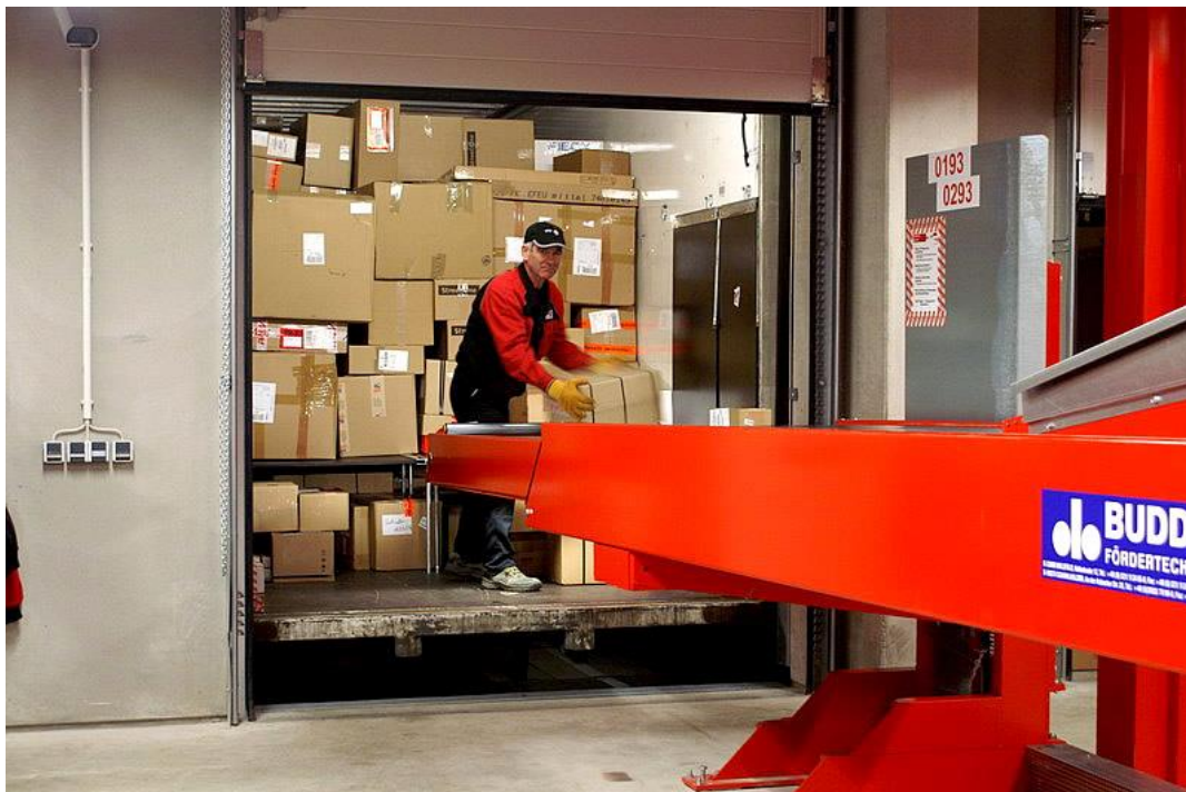
Abbildung 25: Teleskopförderer beim Enladevorgang einer Wechselbrücke (Budde Fördertechnik, o.J.)
