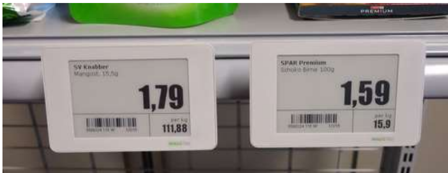
Abbildung 25: Beispiel für elektronische Regaletiketten mit der E-Paper Technologie (Schellbach, 2012)
