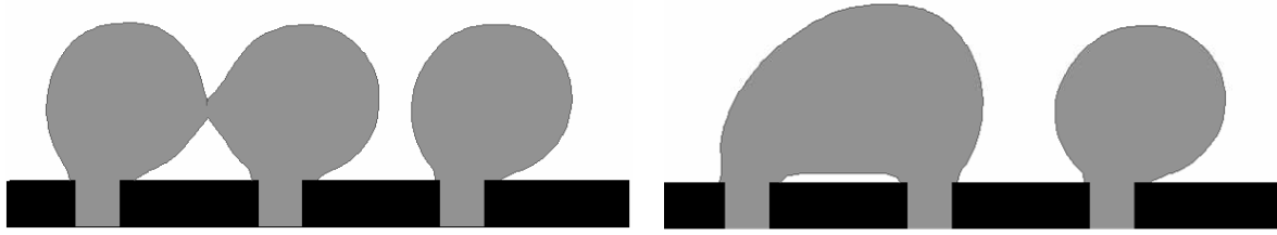
Bild 22: Ungehemmte Koaleszenz am Porenauslass mit dem Standard-VOF-Modell
