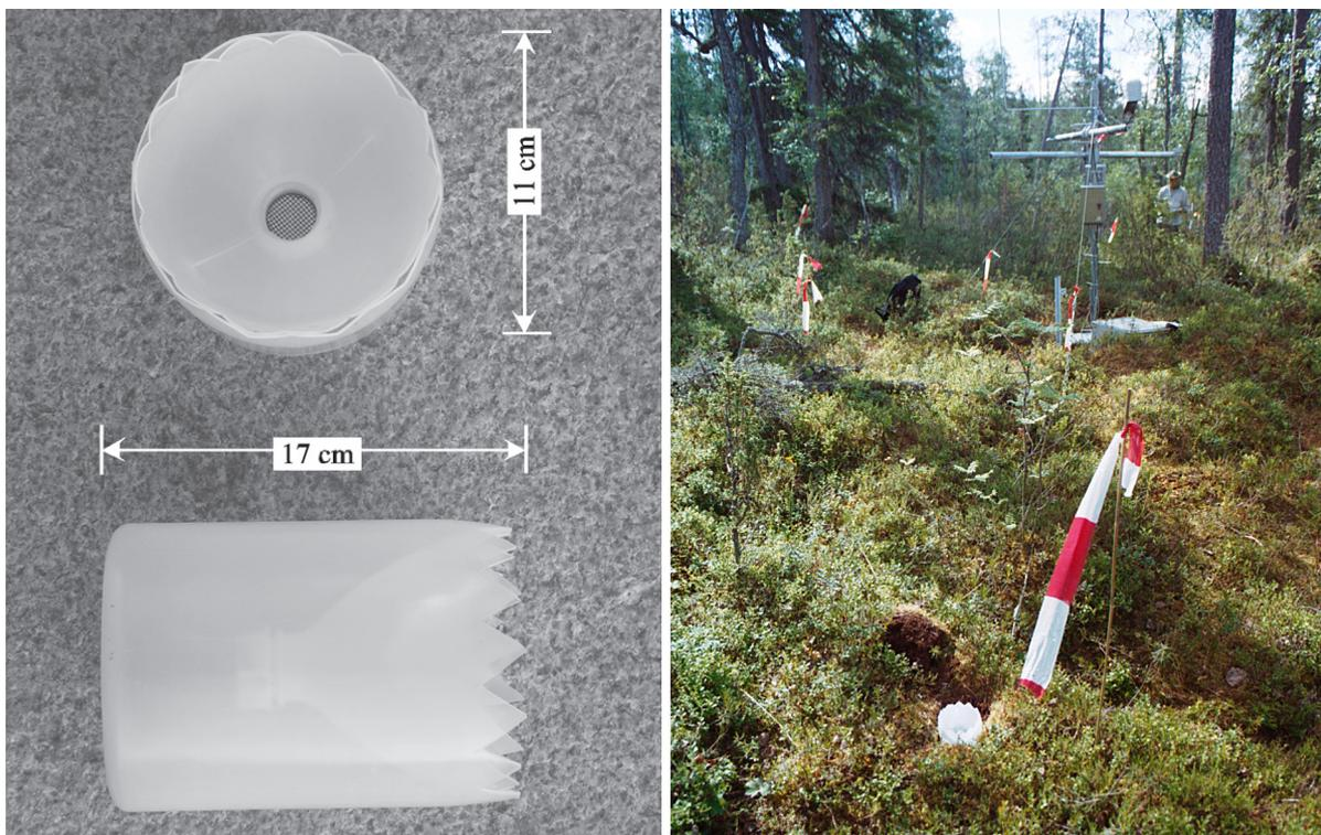
Abb. 20: Maße der Eigenbau-Pluviometer und Beispiel für die Installation auf der Altbestandsfläche
