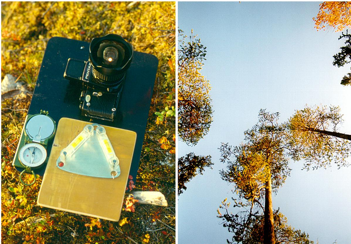
Abb. 22: Aufnahmekonstruktion zur Erhebung der Kronenschlussdichte und Beispielfoto (Altbestand; Kronenschluss über dem Globalstrahlungsgeber)
