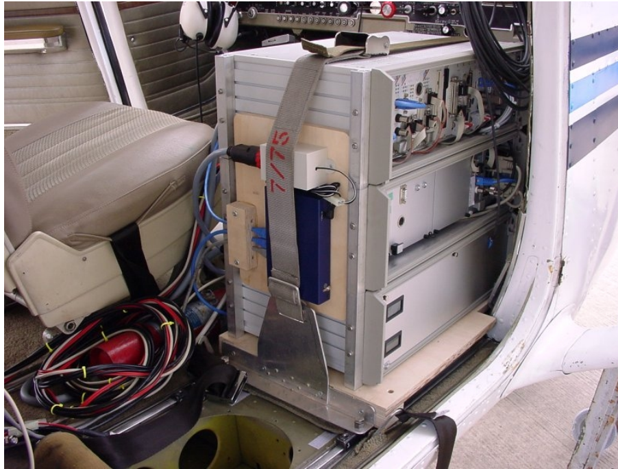
Abbildung 4-27: Hardware-Racks des AISA-Akquisitionssystems (von oben nach unten: DAQ-Rack, optionales Navigations-Rack, Stromversorgungs-Rack; an der Seite: Netzwerk-Plattform) (AIROBOTICS 2003).
