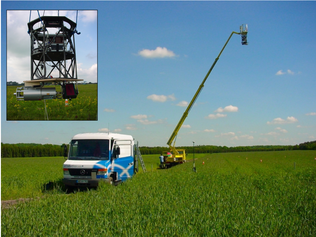
Abbildung 4-2: Krangestützte Vermessung. Oben links: Sensorikträger mit dem Laserscanner und dem Hyperspektralscanner AISA. Optional kann auch eine Digitalkamera an den AISA-Scanner fixiert werden.
