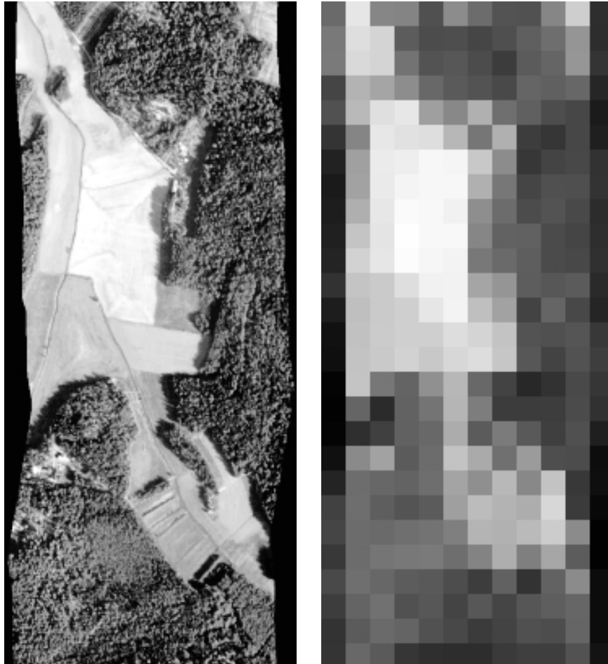
Abbildung 2-10: Beispielhaft dargestellt ist der Unterschied zwischen der räumlichen Auflösung eines flugzeuggestützten (AISA aus 2000 m Flughöhe, Bodenpixel 2 \times 2 \text{ m}^2 , links) und eines satellitengestützten (z. B. Landsat TM, Bodenpixel 30 \times 30 \text{ m}^2 , rechts) Sensors. Man beachte die Zunahme von Mischinformationen (Schatten, unterschiedliche Nutzungsform) bei geringer räumlicher Auflösung.
