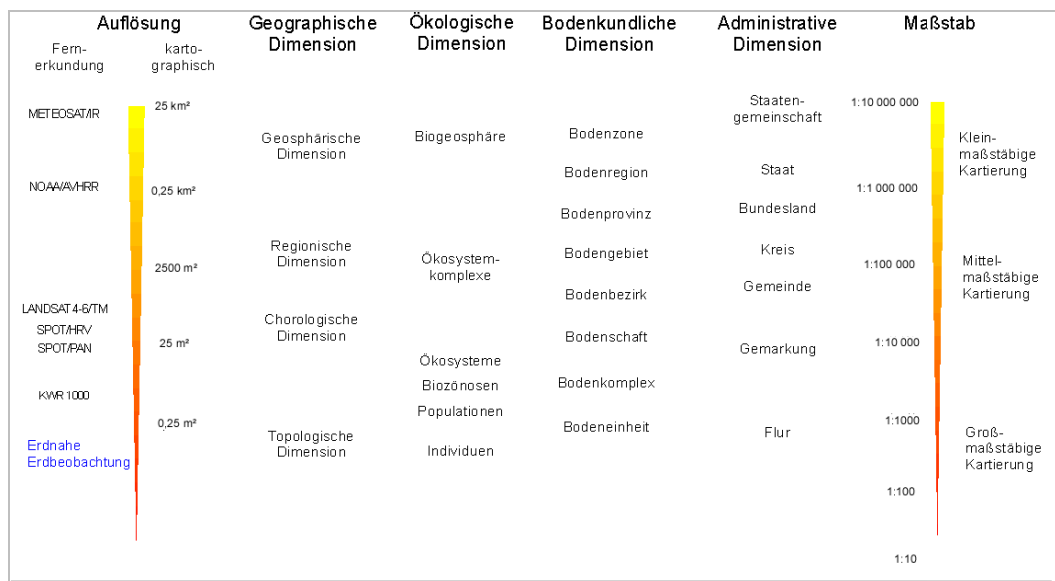
Abbildung 3-1: Darstellung der administrativen Nutzerhierarchien sowie verschiedener Informationsdimensionen in Bezug auf genutzte Karteninformation und auf das Fernerkundungspotenzial (verändert nach BARUTH et al. 1996).
