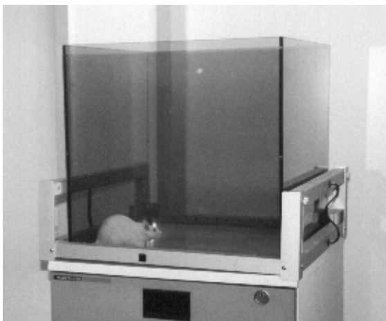
Abb.22: Dargestellt ist eine der drei Photocell-Boxen, mit deren Hilfe die lokomotorische Aktivität gemessen wurde. Erklärung siehe Text.
