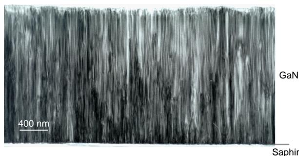
**Abbildung 4.37:** TEM-Querschnittsaufnahme der 1870 nm dicken GaN-Schicht auf einem 3 nm dicken GaN-Puffer.
