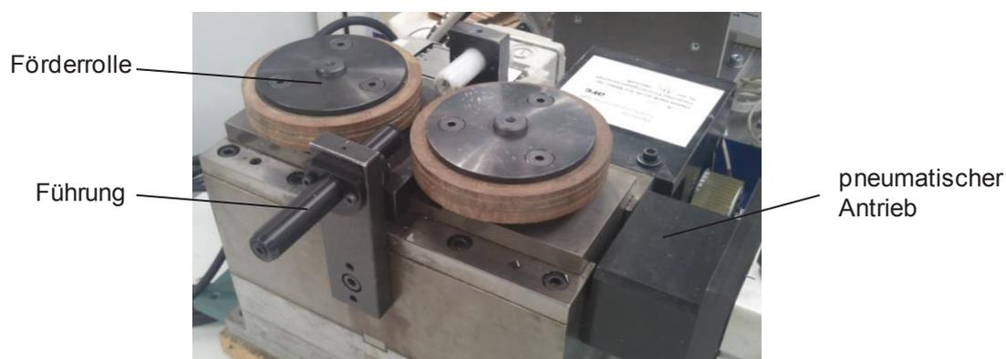
**Bild 4-4: Rollenvorschub mit einem pneumatischen Antrieb zur Schließung der Rollen**
