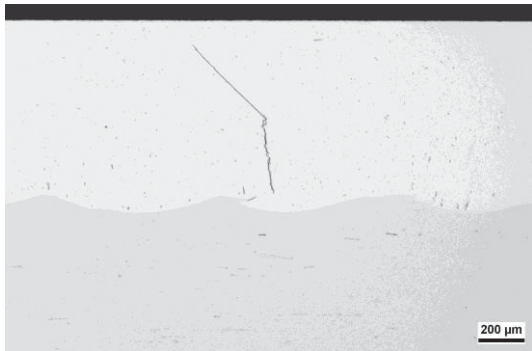
Bild 5-28.: Rundprobenlängsschliff eines mit 1 m/min beschichteten Durchläufers des Stahls 42CrMo4 ( R = -1 ; \sigma_a = 184 MPa; N_B = 10.000.000 ), nach [Sch14b]
